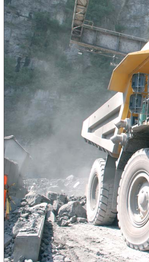
Tombereau Komatsu HD785-5 au déchargement, au poste primaire de la SCT
